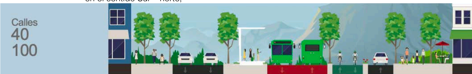
ILUSTRACIÓN 3. DISTRIBUCIÓN DEL ESPACIO EN VÍA POR TRAMOS DEL CORREDOR VERDE DE LA CARRERA SÉPTIMA. *Fuente: IDU
