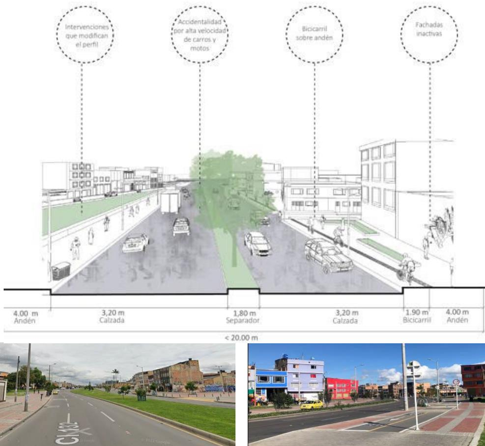
Figura 21. Caracterización perfil tipo F
